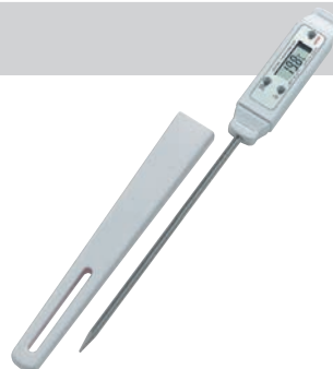
C4350-1A Žákovský digitální teploměr, 200 °C S kovovým zapichovacím snímačem 125 mm a ochranným pouzdem, LC-ukazovatel rozsah měření : -40 ... +200 °C (-40 ... +392 °F) přesnost : +/- 1 °C, rozlišení : 0, 1 °C, funkce : data Hold, maximální a minimální teplota, napájení baterií, automatické vypínání
