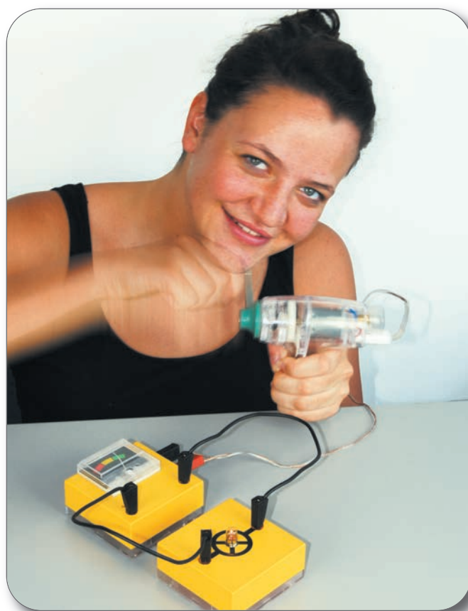
Zásobník energie s ukazatelem (princip hybridního pohonu)
