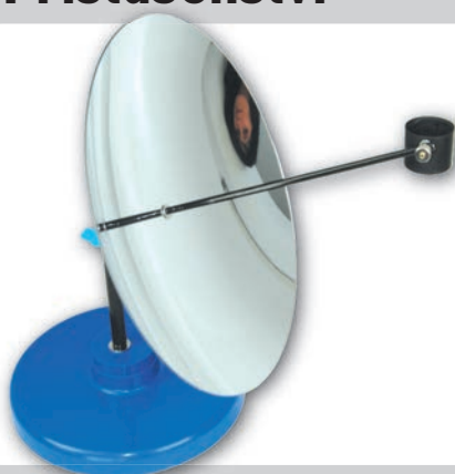
P2885-1P Parabolické zrcadlo 300 mm s podstavcem Soustředěním tepelného záření se v ohnisku dutého zrcadla vytvoří vysoká teplota; parabolické zrcadlo z plastu, v ohnisku upevněná malá kovová nádoba na ohřátí materiálů, velká základna a rukojeť s polohovatelným kloubem pro optimální nastavení úhlu ozáření.
