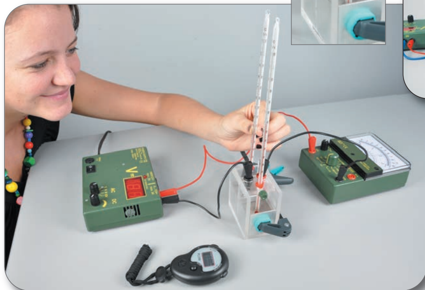
TDS 5.2 Termoelektrické chlazení „Peltierův efekt“
