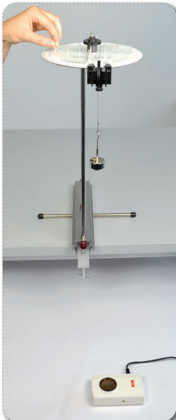
Zákon úhel - čas při rovnoměrně zrychleném rotačním pohybu
