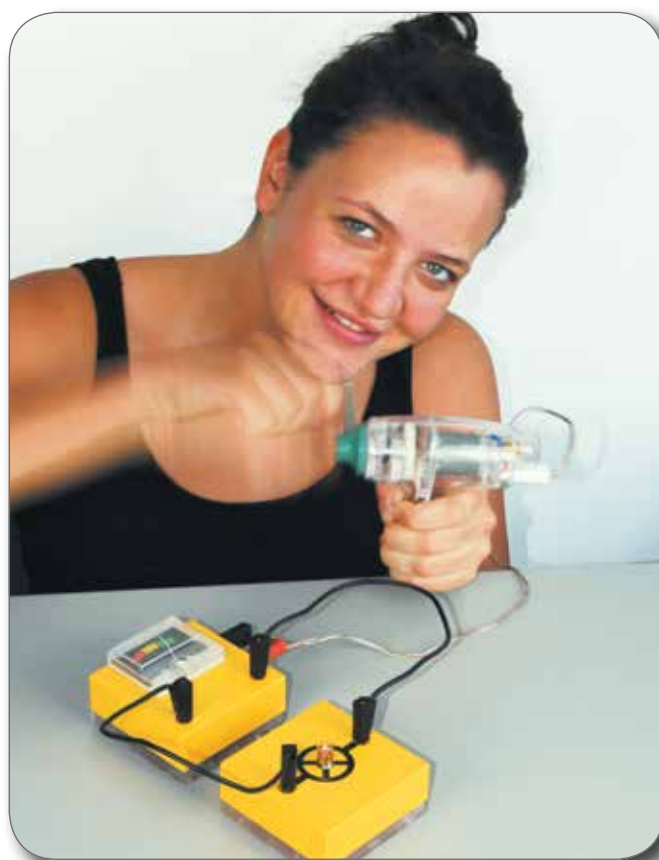
Zásobník energie s ukazatelem (princip hybridního pohonu)
