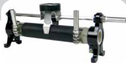
DE720-9S Posuvný odpor 20 Ohm, 2 A Posuvný odpor v otevřeném vyhotovení, aby byl dobře viditelný jezdec na odporovém vinutí; s 3 zdičkami pro bezpečnostní nebo laboratorní vodiče s 4 mm banánky. Odpor: 20 Ohm, zatížitelnost: 2 A (krátko i více). Napětí: max. 42 V, rozměry: cca 150 x 65 x 40 mm
