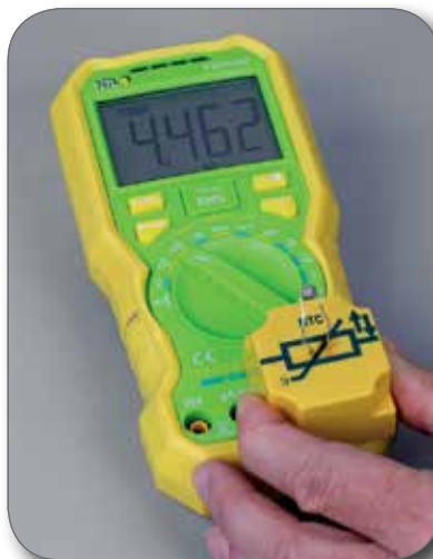
EOS 1.2 NTC odpor (s P3245-1M Ruční digitální multimetr)
