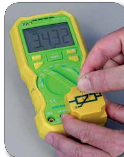
EOS 1.2 NTC odpor (s P3245-1M Ruční digitální multimetr)
