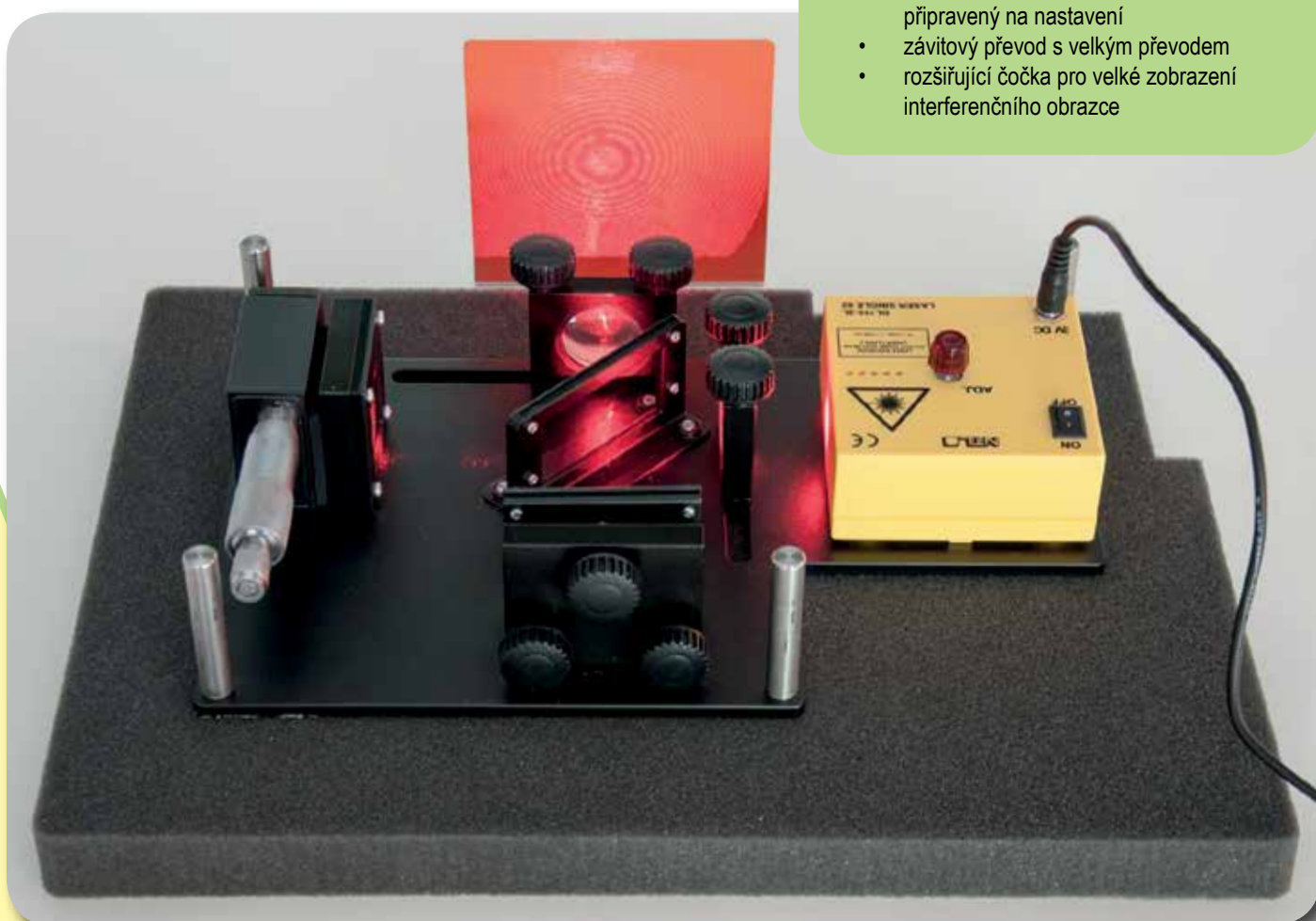
Sestavení pokusu s Laserovým zdrojem 02, držený magnety, DL110-2L. Tento laser je možné uložit i do tvarové vložky v boxu.
