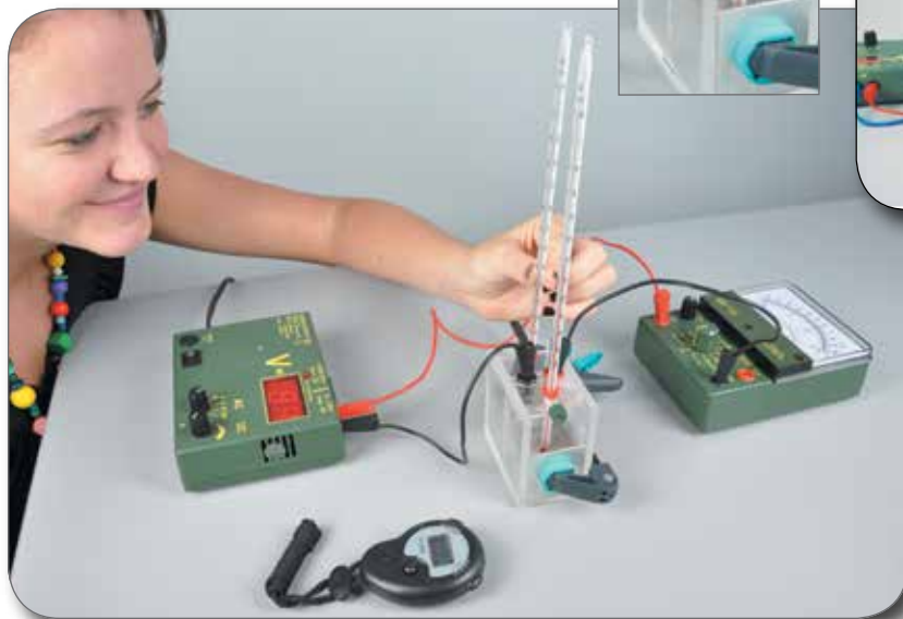
TDS 5.2 Termoelektrické chlazení „Peltierův efekt“
