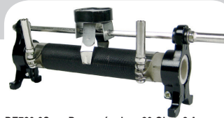
DE720-9S Posuvný odpor 20 Ohm, 2 A Posuvný odpor v otevřeném vyhotovení, aby byl dobře viditelný jezdec na odporovém vinutí; s 3 zdílkami pro bezpečnostní nebo laboratorní vodiče s 4 mm banánky. Odpor: 20 Ohm, zatížitelnost: 2 A (krátko i více). Napětí: max. 42 V, rozměry: cca 150 x 65 x 40 mm
