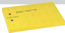
P3120-3B Nabíjecí panel Aku Pro nabíjení v boxu „Elektřina 1“ uložených ŽSP bateriových prvků (akumulátorů) 1,2 V (P3910-2K), (max. 18 ks současně).
